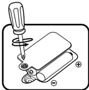
4. Installare 2 batterie AAA nuove seguendo lo schema all'interno dello scomparto delle batterie. (Per avere prestazioni migliori si consigliano batterie alcaline o ricaricabili Ni- MH completamente cariche.)
